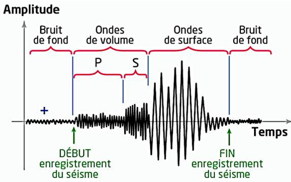
Un **sismogramme** est une représentation graphique du mouvement du sol suite à l'arrivée de trains d'ondes sismiques se propageant depuis le foyer du séisme. On distingue les **ondes sismiques de volume** des **ondes de surface**.
